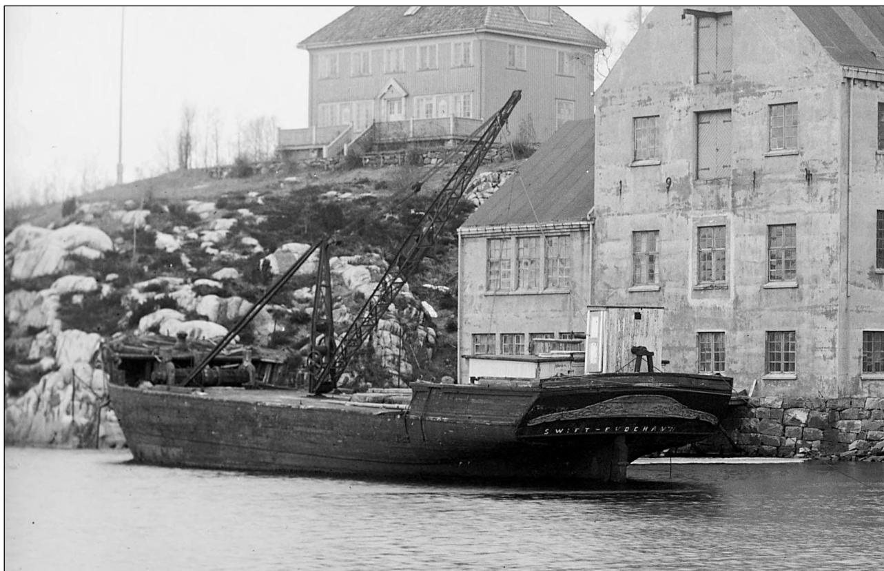
Barken Swift fra Eydehavn som holk (lekter). Den ble nedrigget i 1909. Det er montert en kran på dekket. Utsnitt av foto. Fotograf: Anders Beer Wilse. Bildenummer: 15759B Wilse. Bildedato: 01.07.1922. Bildekilde: Nasjonalbiblioteket. Skipsinformasjon: skipshistorie/net
